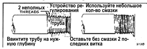
РИС. 5 – ИСПОЛЬЗУЙТЕ УМЕРЕННОЕ КОЛИЧЕСТВО КОМПАУНДА ДЛЯ ТРУБ.
