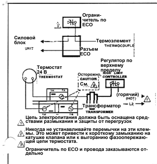
РИС. 9 ТИПОВАЯ СХЕМА ПОДКЛЮЧЕНИЯ ДЛЯ СИСТЕМ 24 В
